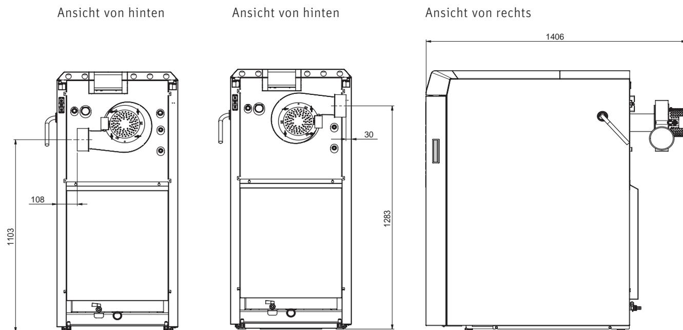
Fig. 12 LogWIN Klassik Abgasgebläse mit Adapter am Kessel
