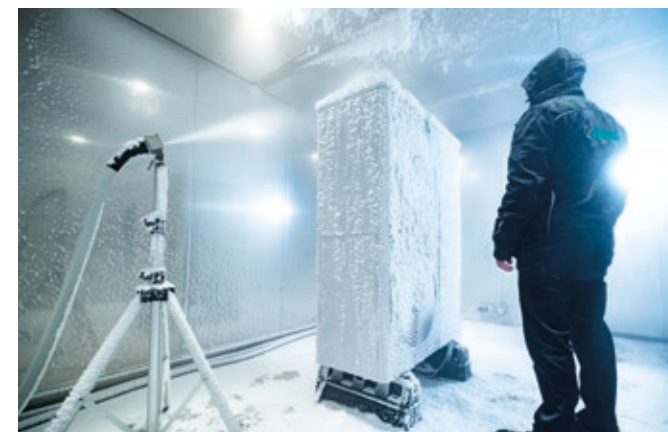
Prüfteams testen die Geräte unter extremen Klimabedingungen in der Klimakammer.
