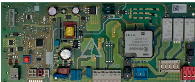
Elektronikplatine der Außeneinheit aroCOLLECT
