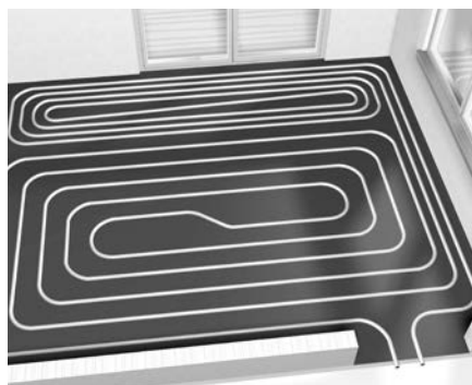
Abb. 3: schneckenförmige Verlegung mit integrierter Randzone
