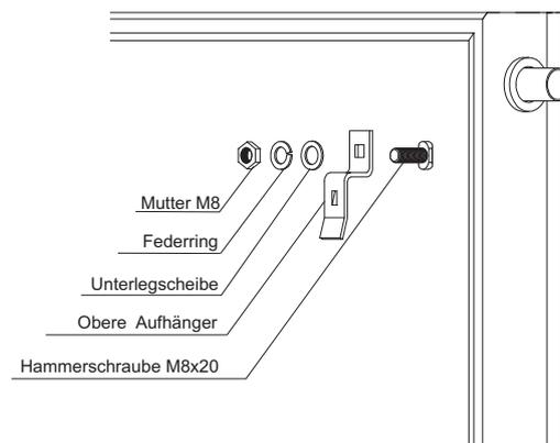
Den oberen Aufhänger anbringen und mit der Schlossschrauben M8x20 leicht anziehen
