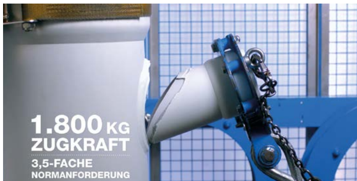
Prüfung am Beispiel POLO-ECO plus PREMIUM DN 400/160/45°
