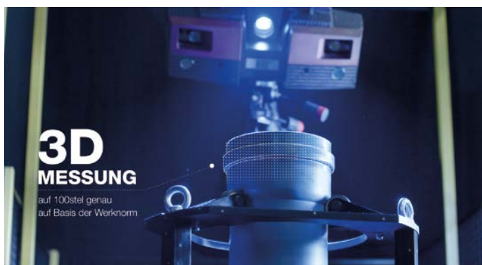
POLO-KAL NG DN 200 bei der Vermessung
