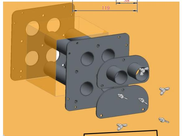
Löcher für die Rohrstutzen bohren D= 54 mm
