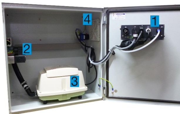
Abbildung 6: Seitenansicht des Innenschaltschrankes mit den vier Schlauchanschlüssen
