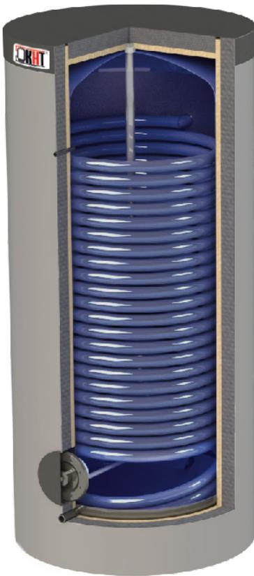
Die Wassererhitzer der Serie KHT BTM-C GP-PS sind speziell für den Einsatz in Niedertemperatursystemen konzipiert, die mit Wärmepumpen und Brennwertkesseln arbeiten. Dies führt zu einer erheblichen Senkung der Energiekosten. Der speziell entwickelte spiralförmige Wärmetauscher mit vergrößerter Wärmeaustauschfläche verkürzt die Aufheizzeit und sorgt für eine hohe Effizienz des Erhitzers.
