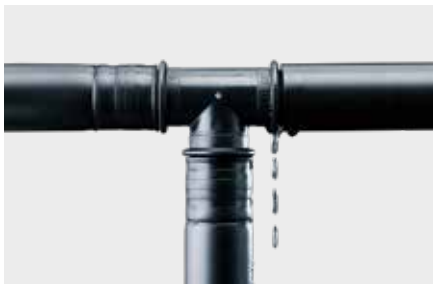
Definierte Leckagepfade machen nicht verpresste Fittings bei der Druckprüfung sofort sichtbar.
