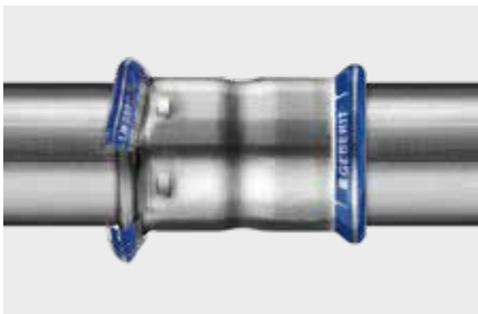
Farbige Indikatoren zeigen nicht verpresste Ma-press Fittings schon vor dem Drucktest.
