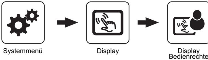
In diesem Menü werden die Bedienrechte der einzelnen Raumbediengeräte vergeben. Ist der Zugriff von einem Raumbediengerät an einer Heizungsumfeldkomponente erlaubt, ist der entsprechende Parameter auf „JA“ zu stellen. Die Anzahl der Menüs sowie Parametereinträge ist abhängig von der Anlagenkonfiguration!
