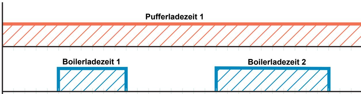
**Tipp:** Bei Anlagen mit Pufferspeicher und Solaranlage wählt man die Pufferladezeit so, dass die Energie der Sonne genutzt werden kann.
