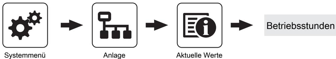
Anzeige der aktuellen Anzahl der Betriebsstunden des jeweiligen Aggregats, der jeweiligen Komponente. Die angezeigten Parameter sind abhängig von der Kesselkonfiguration!
