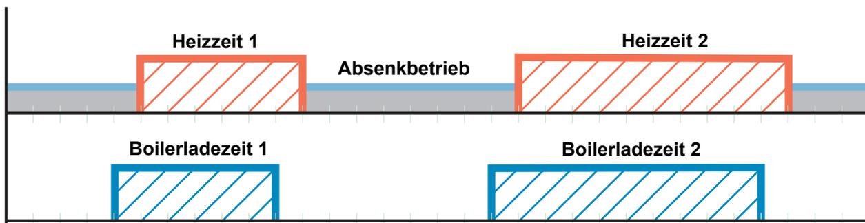
**Tipp:** Bei Anlagen mit Solaranlage wählt man die Boilerladezeit so, dass die Energie der Sonne genutzt werden kann.
