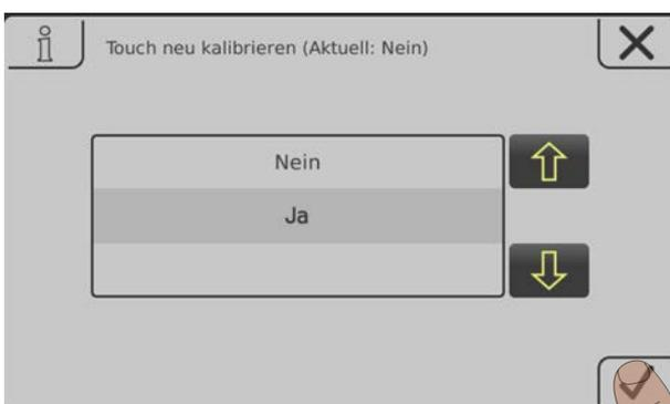
Zum Kalibrieren der Touch-Oberfläche sind 5 Punkte, welche durch ein Fadenkreuz dargestellt werden, in der gezeigten Reihenfolge zu drücken. Nach erfolgter Kalibrierung wird ein Neustart ausgeführt.
