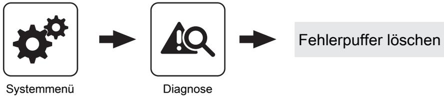
Mit dieser Funktion kann der gesamte Fehlerpuffer gelöscht werden. Ab diesem Zeitpunkt wird der Fehlerpuffer wieder mit neuen Störmeldungen gefüllt.
