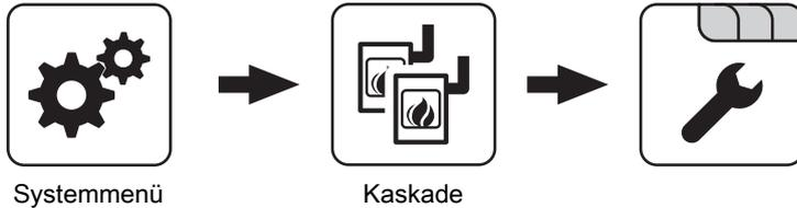
Über die Kesselprioritäten wird die Reihenfolge festgelegt, nach welcher die Kessel gestartet werden. Bei Kessel mit gleicher Priorität startet immer der Kessel mit der aktuell geringsten Betriebsstundenanzahl.
