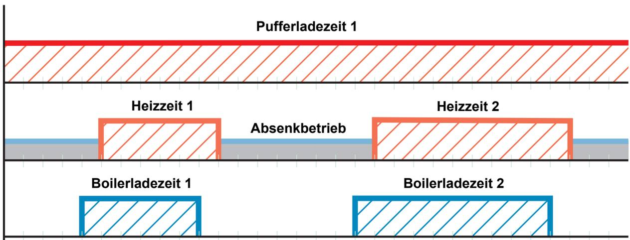
**Tipp:** Bei Anlagen mit Puffer und Solaranlage wählt man die Pufferladezeit so, dass die Energie der Sonne genutzt werden kann.
