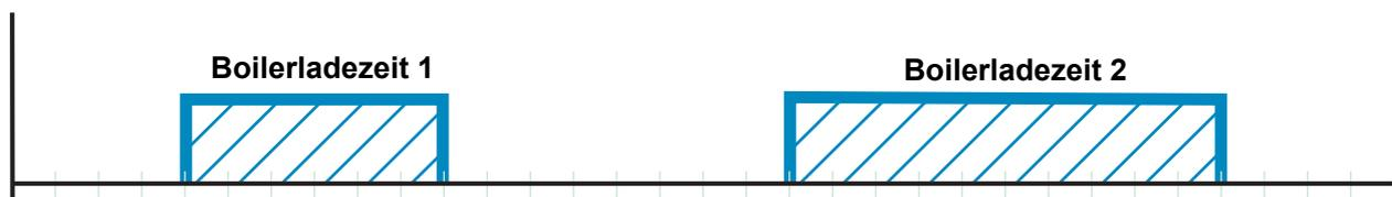
**Tipp:** Bei Anlagen mit Solaranlage wählt man die Boilerladezeit so, dass die Energie der Sonne genutzt werden kann.
