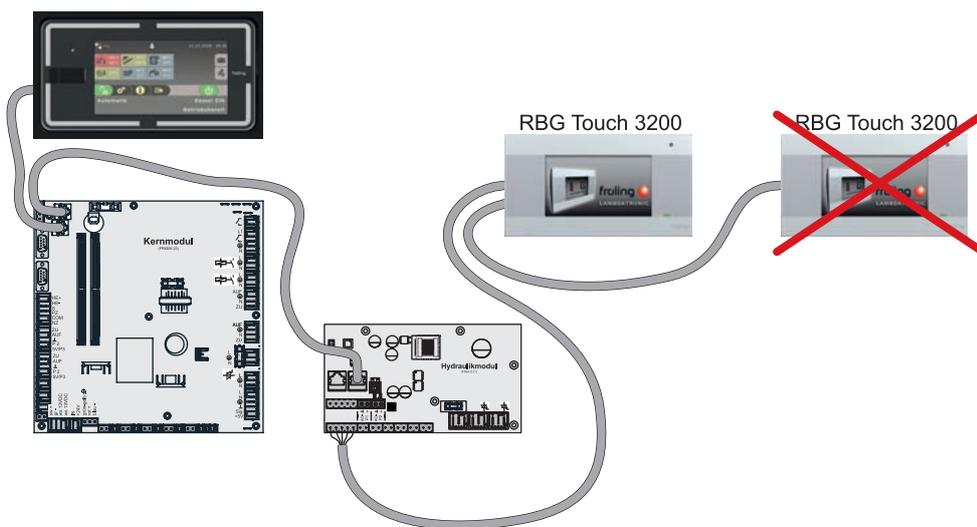
Für jedes Touch-Raumbdiengerät ist ein spannungsversorgendes Modul (Heizkreismodul, Hydraulikmodul) einzusetzen.
