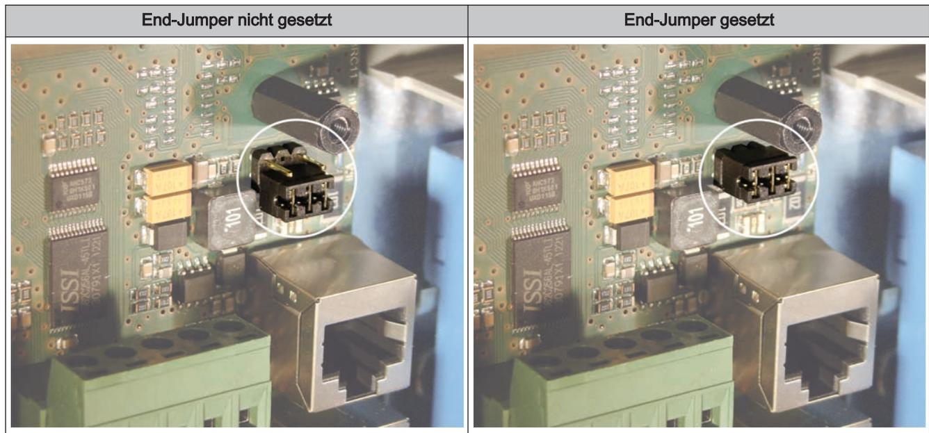
Sind die Kontakte am Sockel des End-Jumpers nicht gebrückt (Bild links), spricht man von "nicht gesetzt". In diesem Fall ist der Bus-Abschluss nicht hergestellt. Sind die Kontakte geschlossen (Bild rechts), ist der End-Jumper gesetzt und der Abschluss der Bus-Verbindung hergestellt.
