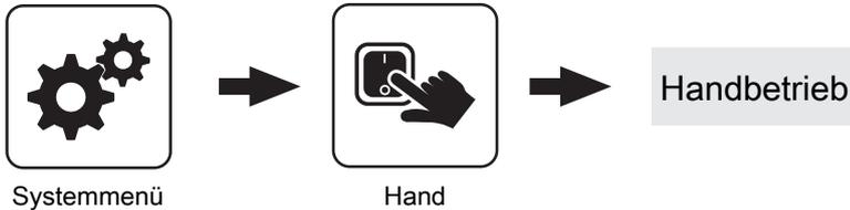
Wird das Menü „Handbetrieb“ verlassen, werden alle aktivierten Parameter automatisch auf „AUS“ gesetzt! Die angezeigten Parameter sind abhängig von der Kesselkonfiguration!
