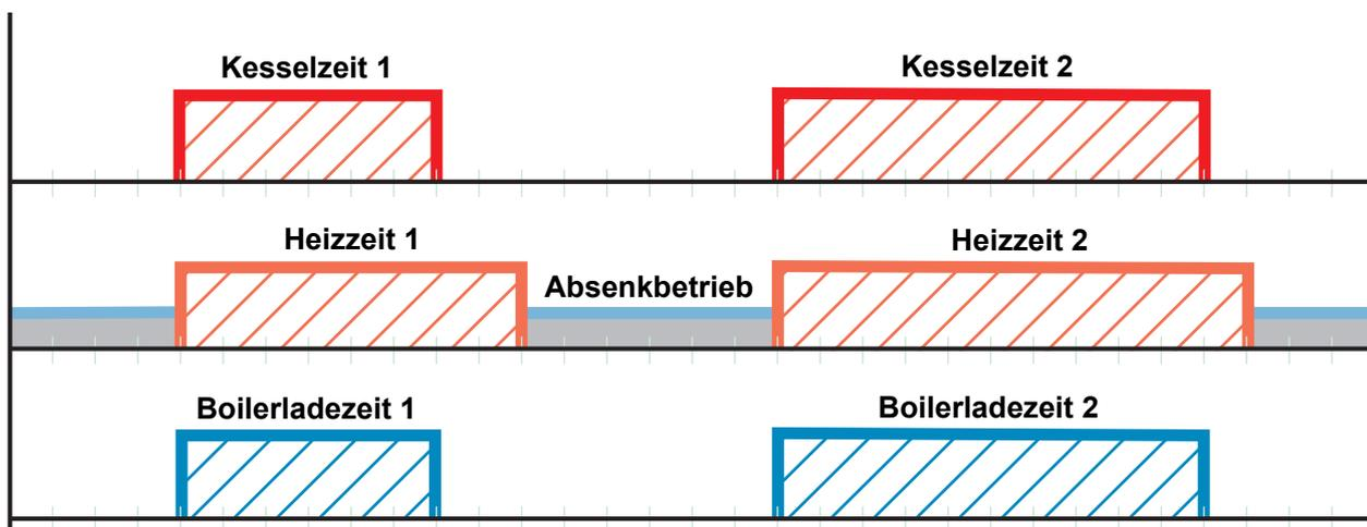
**Tipp:** Bei Anlagen mit Solaranlagen wählt man die Boilerladezeit so, dass die Energie der Sonne genutzt werden kann.
