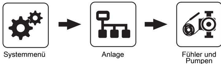
Im Menü „Fühler und Pumpen“ können alle im Hydraulikumfeld vorhandenen Fühlereingänge und Pumpenausgänge zugewiesen werden. Die Anzahl der Parameter ist abhängig von der Konfiguration.
