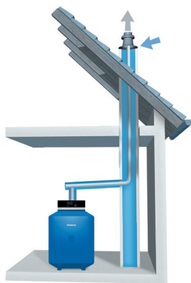
Raumluftunabhängige Aufstellvariante mit eingezogener Kunststoff-Abgasleitung im Kamin.
