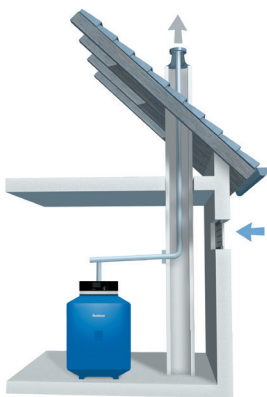
Raumluftabhängige Aufstellvariante mit eingezogenem Abgasrohr im Kamin.
