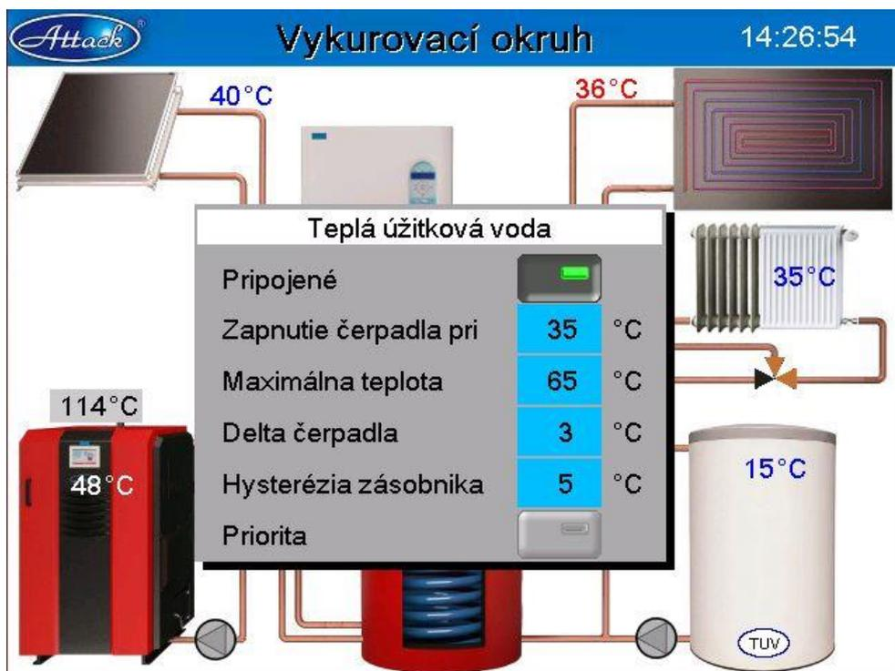
Abbildung Nr. 14 Aktivieren der Erwärmung des Warmwasserspeichers
