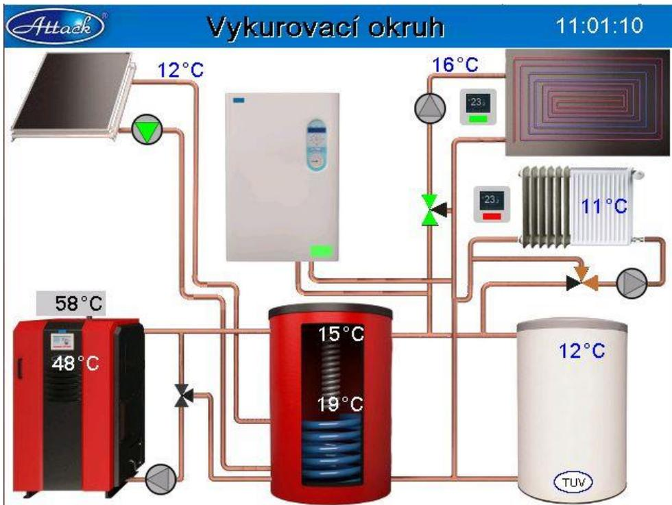
Abbildung Nr. 18 Anzeige der Pumpe in Betrieb und geöffnetes Mischventil.
