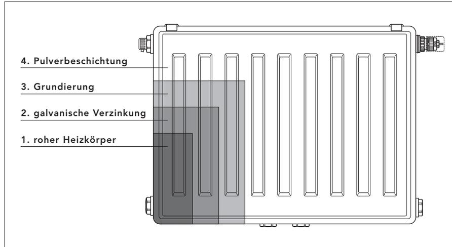
Für Einsatzbedingungen mit erhöhten Korrosionsschutzanforderungen in Räumen mit aggressiver und/ oder feuchter Atmosphäre (wie z.B. Schwimmbäder, Saunen, öffentliche Toiletten, etc.) empfehlen wir unsere KOMPACTHEIZKÖRPER und T6-MITTENANSCHLUSSHEIZKÖRPER in verzinkter Ausführung. Diese Heizkörper
