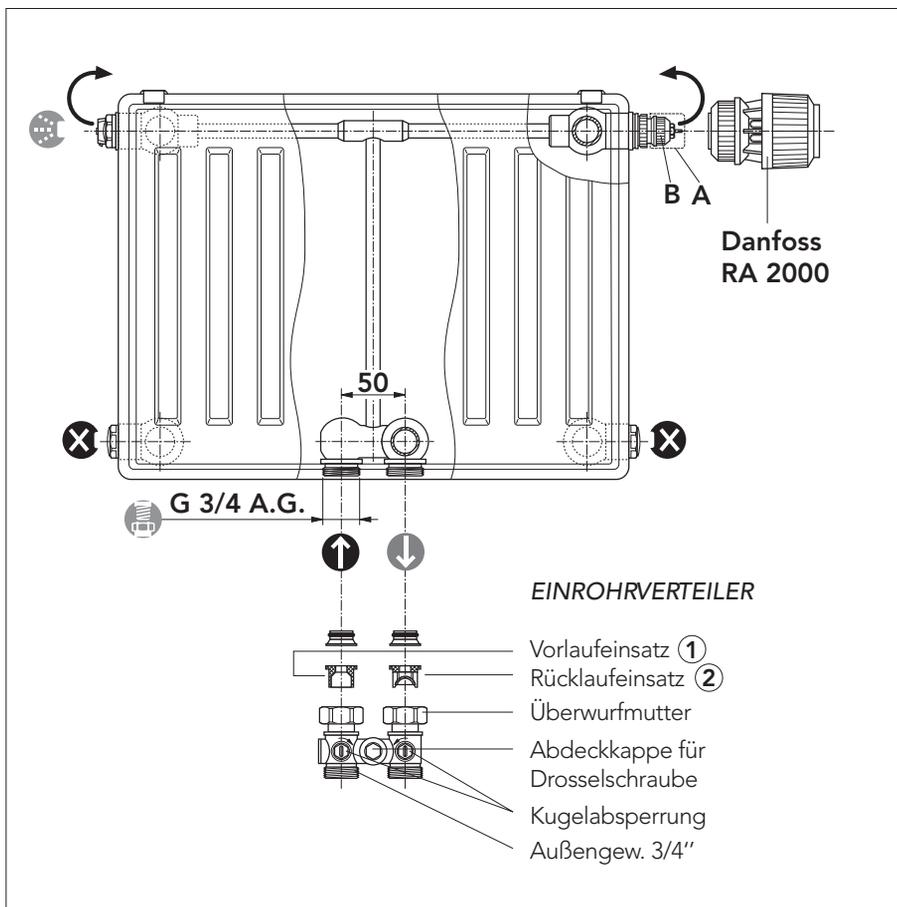
Im Einrohrbetrieb ist das Einbauventil auf N zu justieren.
