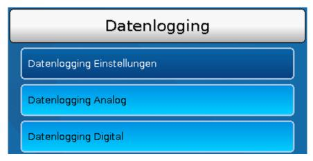
In diesem Menü werden die Einstellungen für das Datenlogging über CAN-Bus oder auf der SD-Karte des Reglers für analoge und digitale Werte definiert.
