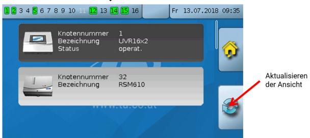
Durch Antippen des Feldes werden die aktiven CAN-Knoten im CAN-Busnetz angezeigt. Mit "**Status**" wird der CAN-Bus-Status des Reglers angezeigt. Der Status wechselt nach dem Reglerstart nach einem vorgeschriebenen Verfahren automatisch von *init.*  $\rightarrow$  *preop*(*erational*)  $\rightarrow$  *operat*(*ional*). Erst dann kann mit anderen CAN-Busgeräten kommuniziert werden.
