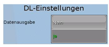
Über diese Schaltfläche kann die Datenausgabe für das Datenlogging über DL-Bus und für die Anzeigen im Raumsensor RAS-PLUS ein- oder ausgeschaltet werden. Für das DL-Datenlogging wird das C.M.I. verwendet. Es werden nur die Ein- und Ausgangswerte und 2 Wärmemengenzähler, aber keine Werte der Netzwerkeingänge ausgegeben.
