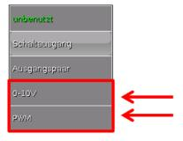
Diese Ausgänge stellen eine Spannung von 0 bis 10V zur Verfügung, z.B. zur Leistungsregelung von Brennern (Brennermodulation) oder Drehzahlregelung von Elektronikpumpen.
