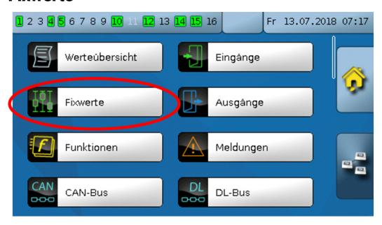
In diesem Menü können bis zu **64 Fixwerte** definiert werden, die z.B. als Eingangsvariablen von Funktionen verwendet werden können.
