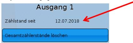
Nach Tippen auf das Schaltfeld wird abgefragt, ob man die **gesamten** Zählerstände und "**Vortag**" des Betriebsstunden- **und** des Impulszählers löschen möchte. Die Zählerstände "**heute**" und "**letzter Lauf**" und "**aktueller Lauf**" werden damit nicht gelöscht.
