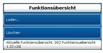
Von der SD-Karte kann die Funktionsübersicht (Datei \*.x2d, **TA-Designer Mindestversion: 1.15**) in das Gerät geladen oder im Gerät gelöscht werden. Es können mehrere Dateien auf der SD-Karte gespeichert sein.
