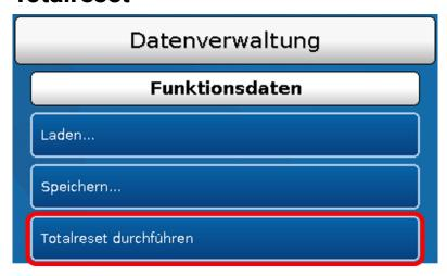
Ein Totalreset ist nur aus der Fachmann- oder Expertenebene nach einer Sicherheitsabfrage möglich. Ein **Totalreset** löscht die Funktionsmodule, die Parametrierung aller Ein- und Ausgänge, Bus-Ein- und Ausgänge, Fix- und Systemwerte.
