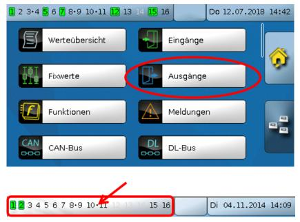
Durch Antippen der Ausgangsanzeige in der oberen Statuszeile gelangt man ebenfalls in das Menü "Ausgänge". Nicht definierte Ausgänge sind ausgeblendet.
