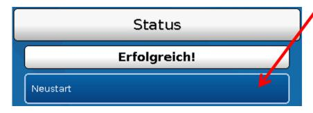
Am Ende des Menüs "Datenverwaltung" besteht die Möglichkeit, einen Neustart des Reglers nach einer Sicherheitsabfrage durchzuführen ohne den Regler vom Netz zu trennen.
