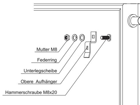
Den oberen Aufhänger anbringen und mit der Hammerschrauben M8x20 leicht anziehen
