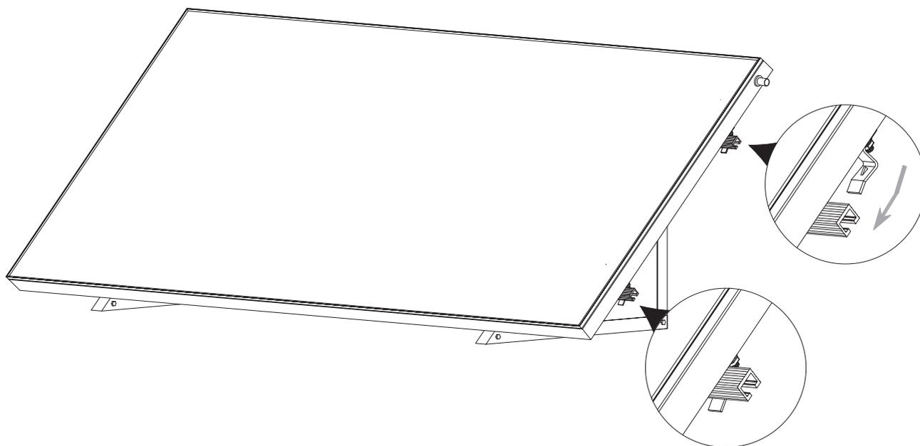
Den Kollektor auf den Balken montieren, dann den Kollektor nach unten schieben und die Schrauben fest anziehen.
