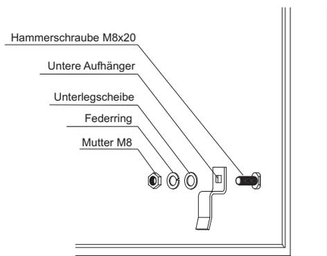
Den unteren Aufhänger anbringen und mit der Hammerschrauben M8x20 fest anziehen
