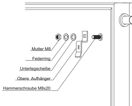
Den oberen Aufhänger anbringen und mit der Hammerschrauben M8x20 leicht anziehen
