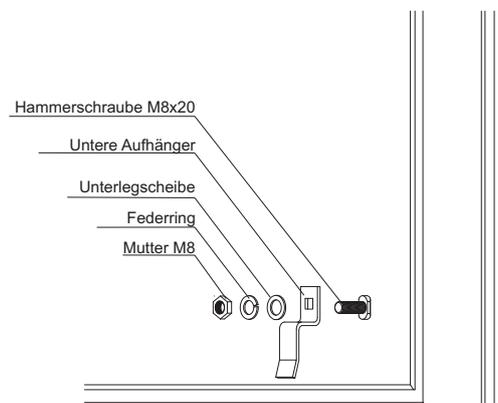
Den unteren Aufhänger anbringen und mit der Hammerschrauben M8x20 fest anziehen
