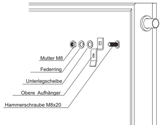
Den oberen Aufhänger anbringen und mit der Hammerschrauben M8x20 leicht anziehen
