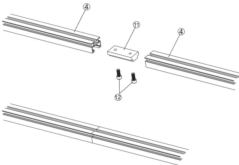
Den Steckverbinder ① in die Aluminiumprofile ④ des Montagesets einschieben und mit Inbusschrauben ② Fixieren.
