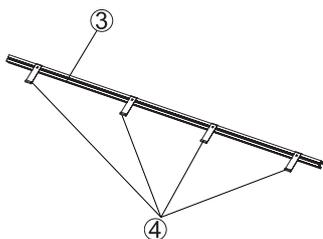
3. Die auf den Aufhängern ④, angehängten Kollektoren, mit der Lasche ⑤ und der Schraube ⑪ fixieren.
