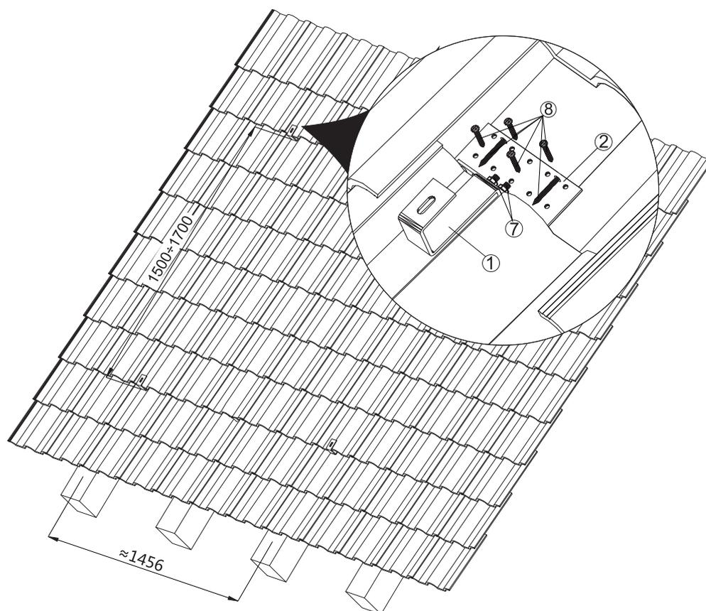
Die Haken anbringen und dann die Dachziegeln wider einsetzen
