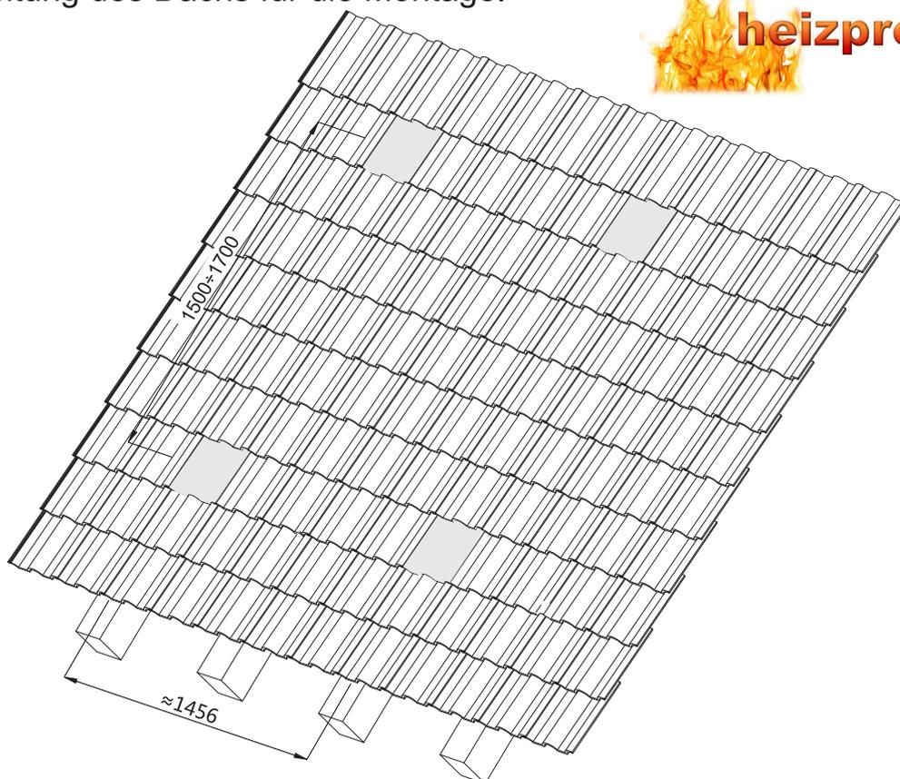
Die Dachziegeln an den angezeigten stellen entfernen
