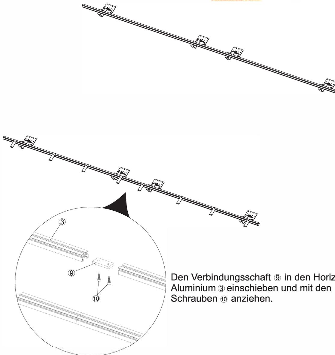
Den Verbindungsschaft ⑨ in den Horizontalbalken Aluminium ③ einschieben und mit den Schrauben ⑩ anziehen.
