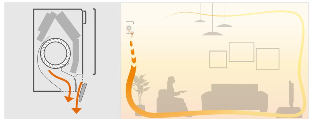
Der Coanda-Effekt erzeugt zwei unterschiedliche Luftstromprofile, je nachdem, ob sich Stylish im Kühl- oder Heizmodus befindet. Die oberen beiden Bilder zeigen den Coanda-Effekt im Kühlmodus (Deckenluftstrom), während die unteren Bilder den Coanda-Effekt im Heizmodus (vertikaler Luftstrom) abbilden.
