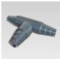
Der Isoliersatz für T-Verbindungen garantiert die vollständige Isolierung und Abdichtung von Abzweigungen. Der Doppel T-Isoliersatz wird bei Abzweigungen von single auf double Rohren eingesetzt. Die Isoliersätze bestehen aus zwei HDPE-Halbschalen, Edelstahlschrauben und einem Schmiermittel gegen das Kaltverschweißen der Schrauben.
