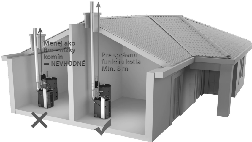
Bild 3. Richtige und falsche Kaminparameter des Kesselanschlusses SLX
