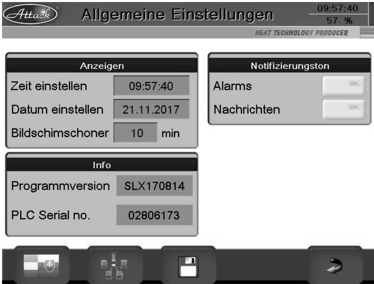
Bild 39. Nach dem Drücken des Schlüsselsymbols werden die Extraeinstellungen abgebildet
