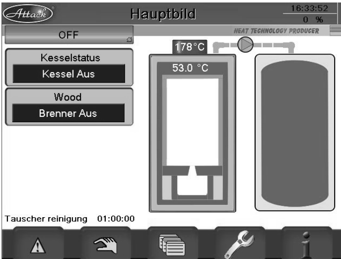
Bild 21. Nach der Wahl des TEST Modus wird das Symbol der Hand auf der unten Leiste, wo es alle elektrischen Anlagen, die zur Elektronik angeschlossen sind, überprüfen möglich ist.
