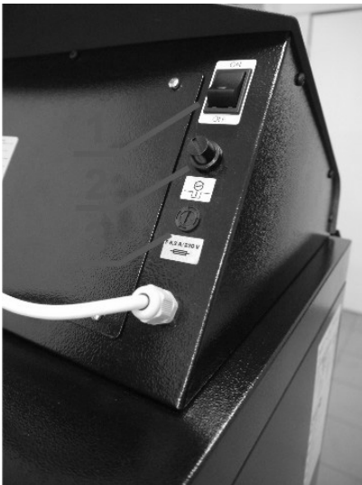
Bild 17. 1 – Hauptschalter, 2 – Havarie Thermostat, 3 – Sicherung (F6,3A)
